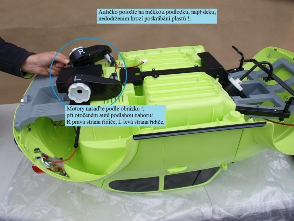
Motory nasad'te podle obrázku !, při otočeném autě podlahou nahoru: R pravá strana řidiče, L levá strana řidiče,
