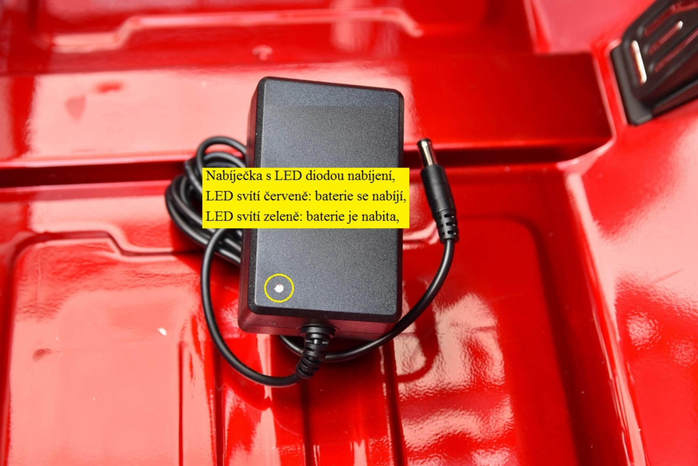
Nabíječka s LED diodou nabíjení,
