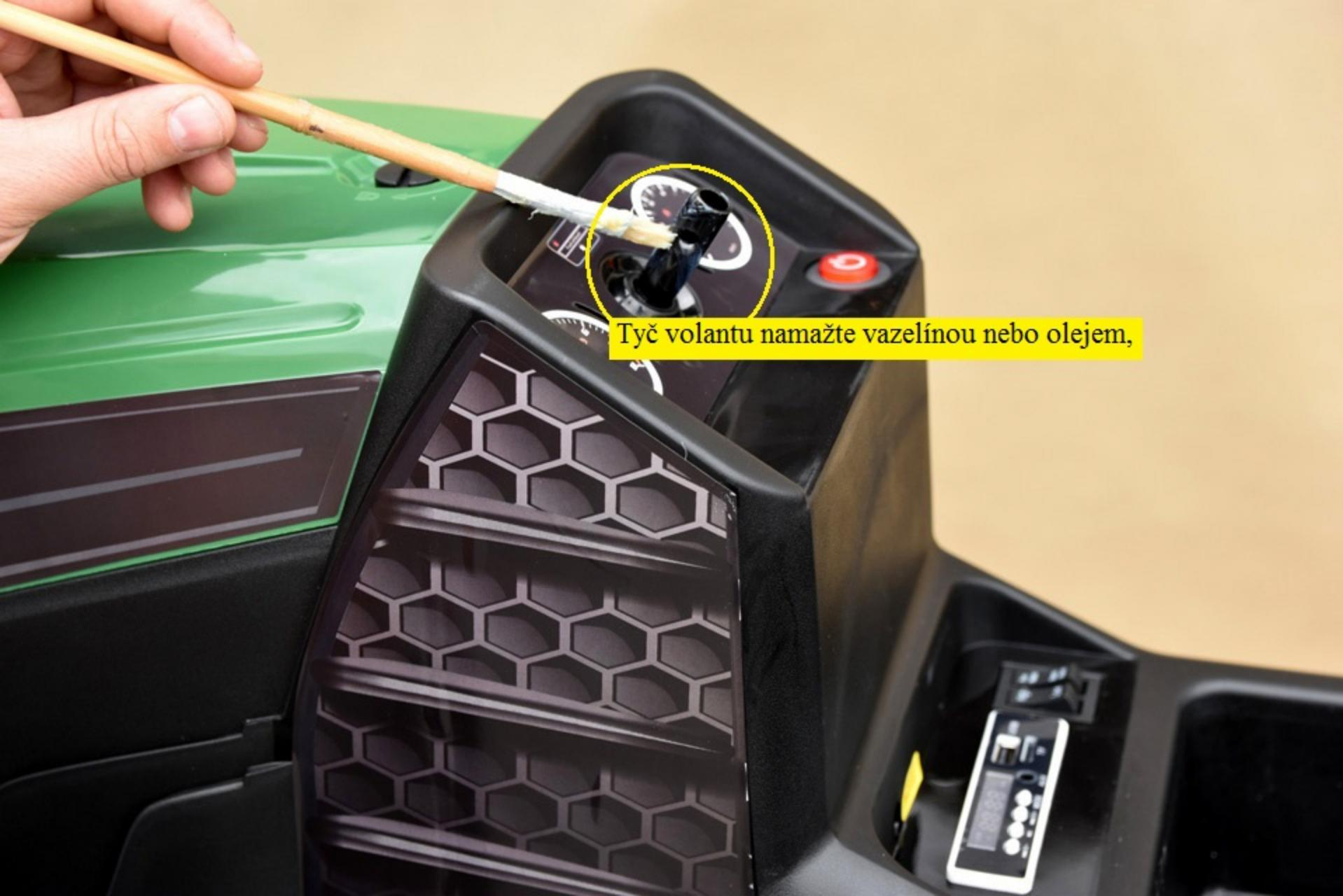
Tyč volantu namažte vazelinou nebo olejem,
