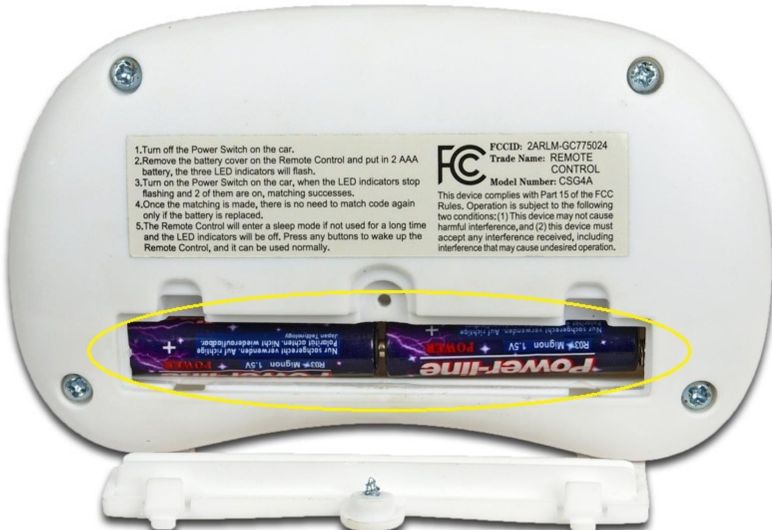
Vložte 2 mikrotužkové baterie R3 AAA, pozor na správnou polaritu + a - !!,
