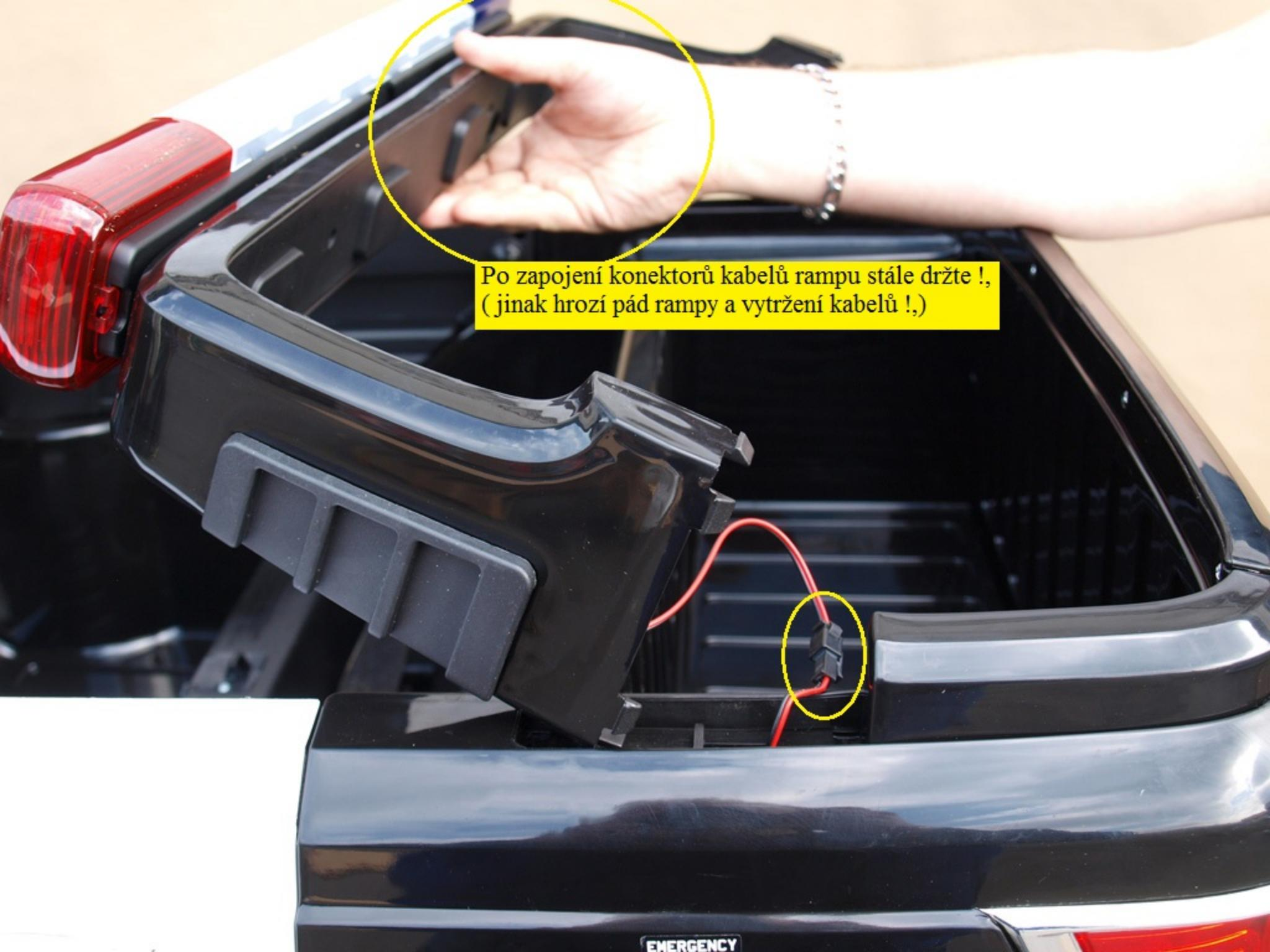
Po zapojení konektorů kabelů rampu stále držte !,
