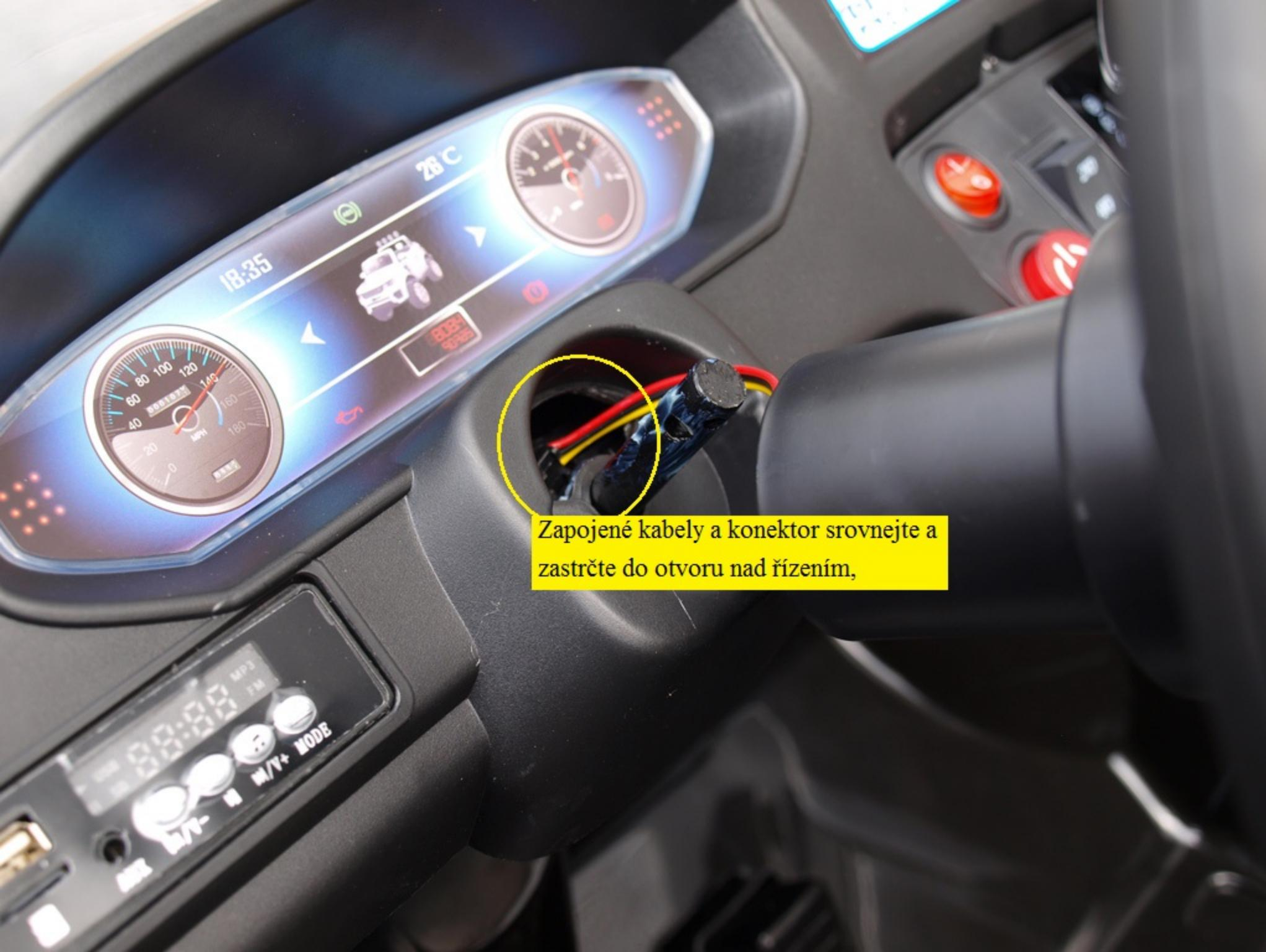
Zapojené káble a konektor srovnejte a zastrčte do otvoru nad řízením,
